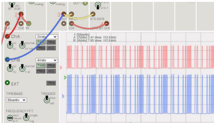
Fig.9. Resultado del laboratorio con medición en la salida del transmisor y del receptor de fibra
