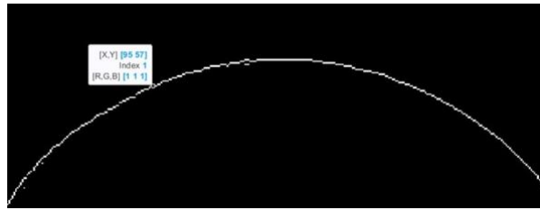
Fig. 3. Técnica de detección de bordes, coordenadas de los píxeles del borde detectado
